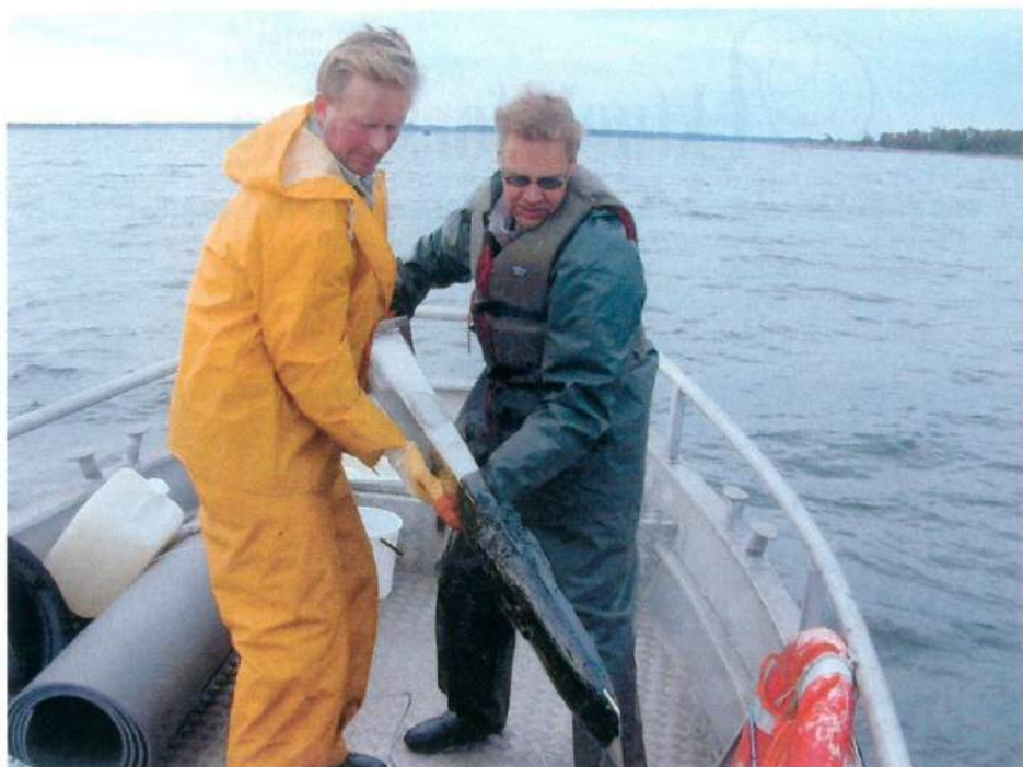
Sedimentprovtagning med nedfrysningsmetod.
