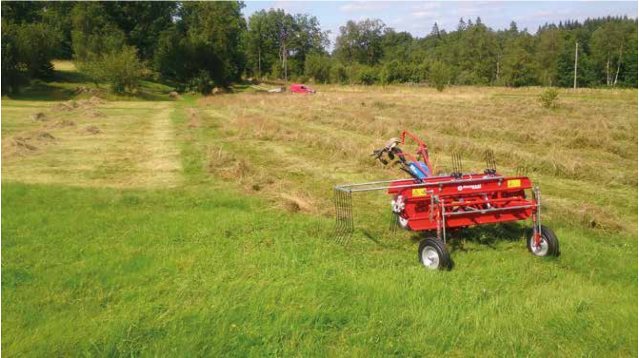
Sidräfsa monterad på enaxlad traktor.
