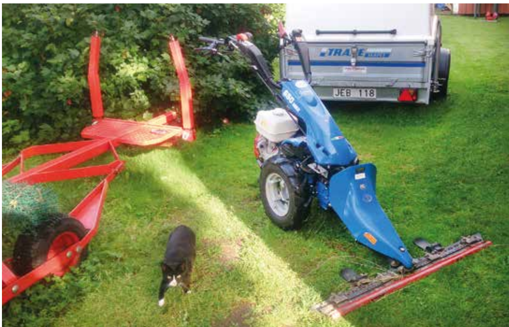
Till vänster: Slätterbalk monterad på enaxlad traktor.
